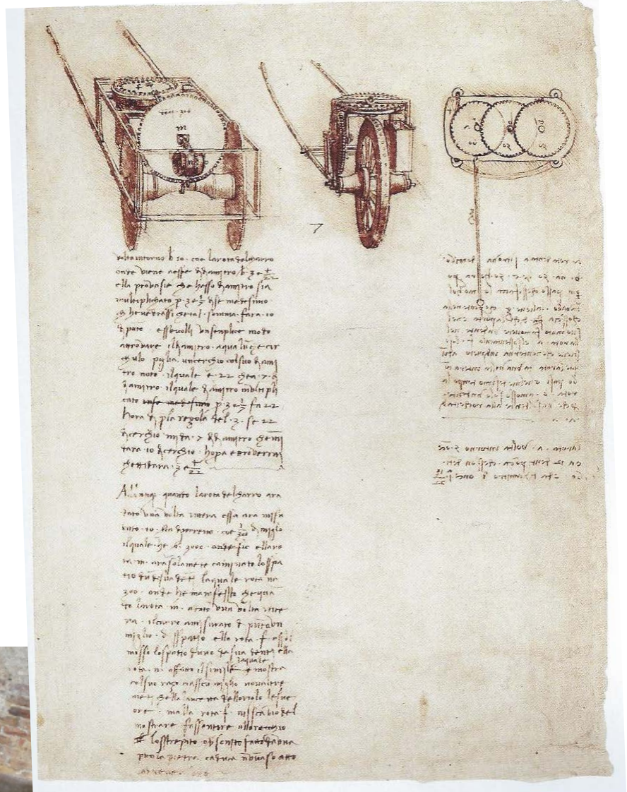
-Debuxos de Leonardo sobre o odómetro, catalogados co número 552 do Códice Atlántico –Milán, biblioteca Ambrosiana- -Odómetro construído segundo os planos de Leonardo
