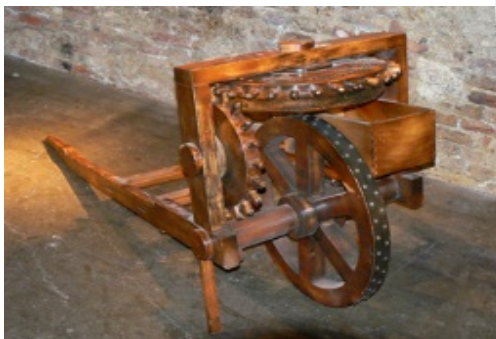
-Debuxos de Leonardo sobre o odómetro, catalogados co número 552 do Códice Atlántico –Milán, biblioteca Ambrosiana- -Odómetro construído segundo os planos de Leonardo
